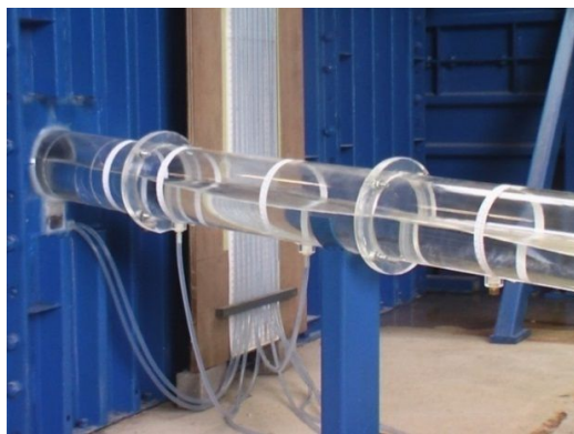
Figure 9 : Ecoulement à surface libre sur le modèle (65 m 3 /s) (à gauche) et niveau piézométrique en fonction de
