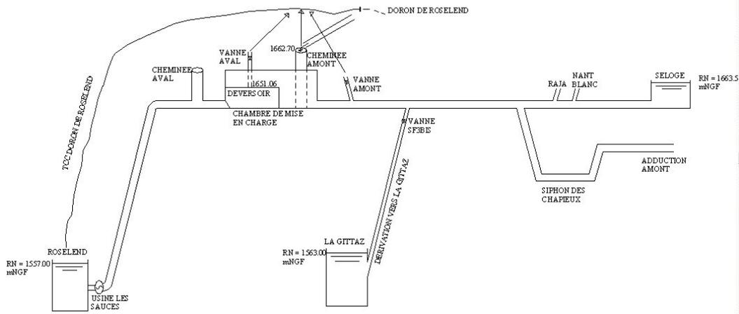
**Figure 1 :** Diagram of Les Saucés scheme
